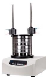
**Step 3** 选择振动筛分仪 SS200 进行筛分，最大 9 级筛分
