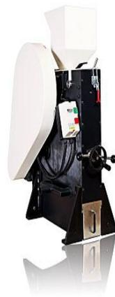
**Step 1** 先选择粗粉碎的设备鄂式破碎仪 JC5 进行预处理，出样细度在 2mm 左右
